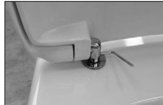
09 Stringere con la chiave in dotazione (brucola) la cerniera sul pin di fissaggio. Tighten the hinge on the screw's pin by using the provided key.
