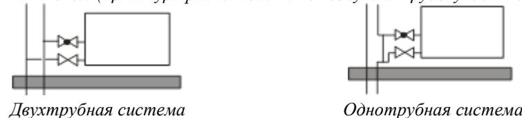
*Горизонтальные, с применением регулирующего H-образного узла подключения с встроенным регулируемым байпасом, например, Jaga 50900.112:*
